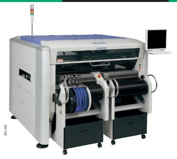
Das Yamaha-Bestückungssystem i-Pulse M20 ist für die High-Mix/ Low-Volume-Fertigung konzipiert, beherbergt einen Hochpräzisionsdispenser der zum Auftrag verschiedener SMD-Pasten und SMD-Kleber dient, und lässt sich an die Software-Architektur Everes problemlos adaptieren.
